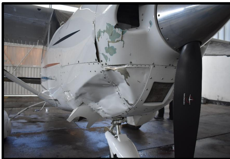
Fotografía No. 4 Daño al Cowling del motor superior e inferior, lado derecho de la aeronave.
