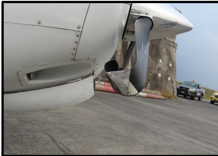
Fotografía No. 8 Vista de los daños en las palas de la hélice de la aeronave.
