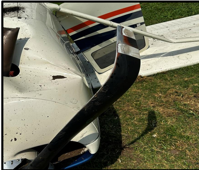
Fotografía No. 4 Vista de la hélice y parte frontal de la aeronave dañada.
