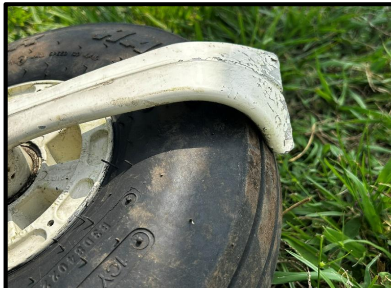
Fotografía No. 8 Vista de la tijera parte superior rota que soporta la rueda de nariz.
