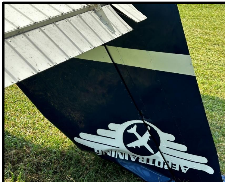
Fotografía No. 10 Vista del daño al estabilizador vertical.
