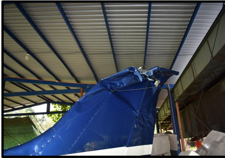
Fotografía No. 11 Vista del daño en el estabilizador vertical de cola.
