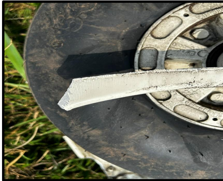
Fotografía No. 7 Vista de la tijera parte inferior rota que soporta la rueda de nariz.
