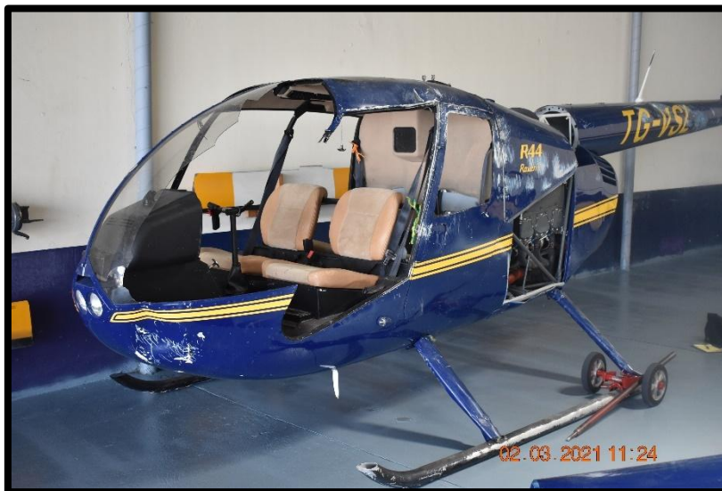
Fotografía No. 6 Vista de daños del lado izquierdo.
