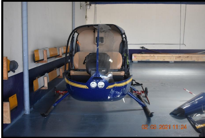
Fotografía No. 5 Vista del daño del frente de la aeronave.
