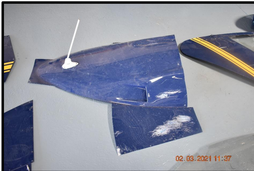
Fotografía No. 12 Vista de cobertores dañados.
