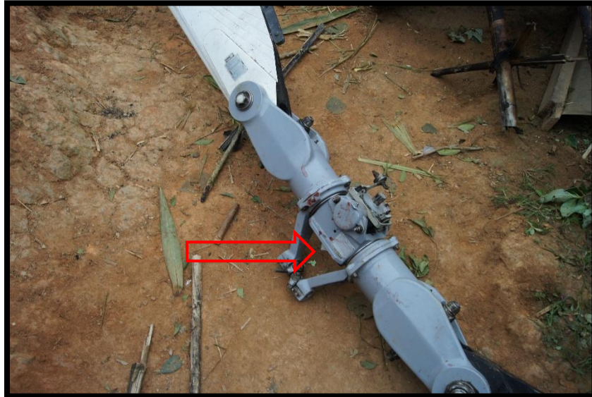
Fotografía No. 7 Vista del hub del rotor principal separado de la transmisión, debido a la fractura del mástil.
