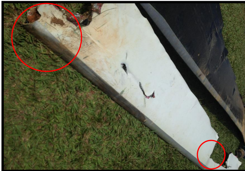
Fotografía No. 12 Vista de la otra pala y sus daños.
