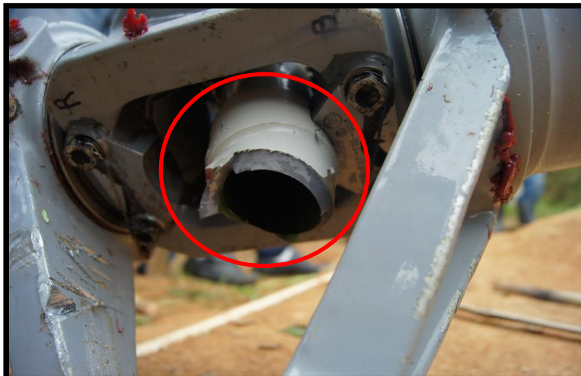
Fotografía No. 8 Vista de la fractura del mástil de la transmisión que une el rotor principal.
