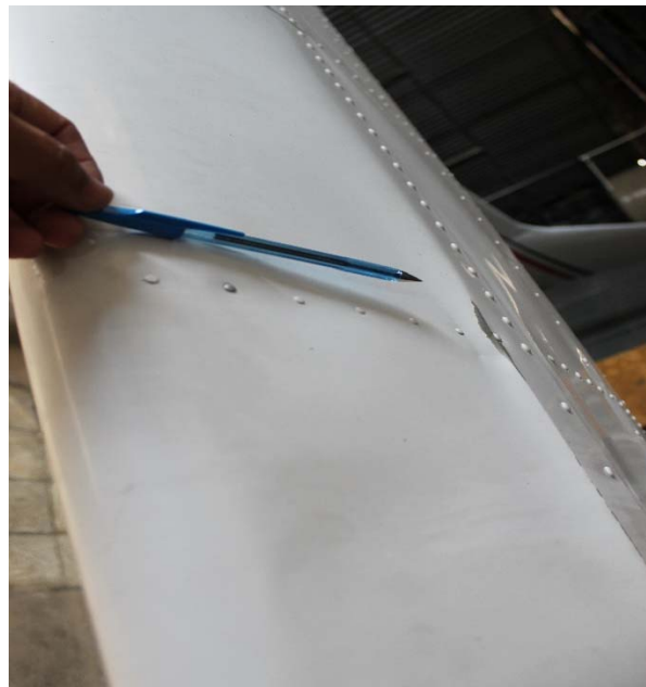
Fotografía No. 6 Vista del daño ocasionado por el ave.
