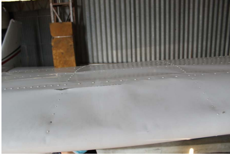
Fotografía No. 5 Daño por compresión.
